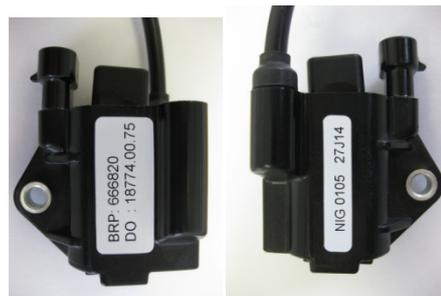
Gleiche Zündung für alle Motoren mit einer separaten Elektronik Box (ECU, speziell für jeden Motor).
