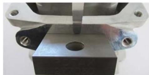
Das Anpassen der Dichtung (Rotax Nr. 250 231) zwischen Zylinder und Auslasschiebergehäuse ist verboten.
