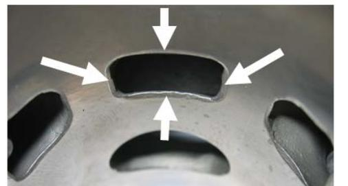
Zylinder welche mit dem Code 223 993 oder 223 994 beschriftet sind, können am oberen Punkt des zentralen boosters eine mechanische Bearbeitung aufweisen.
