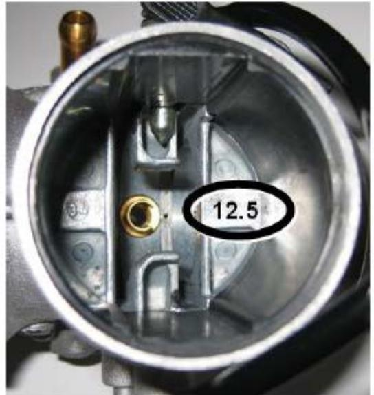
Bohrung des Vergasereinsatzes
