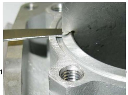
Die Lehre muss in den Zylinder eingeführt werden (Achtung, richtiges Messmittel JUN, MAX oder DD2 wählen)
