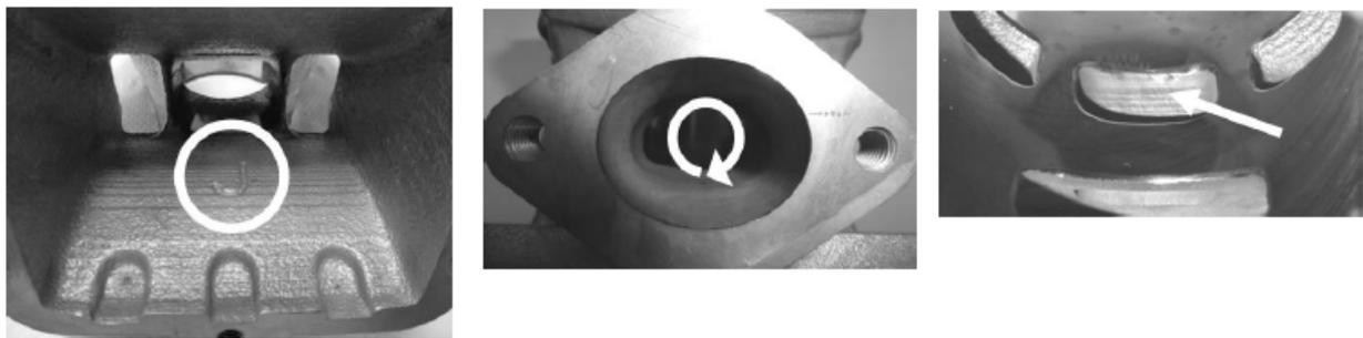
Die horizontalen sowie vertikalen Dimensionen des Auslasskanals (Zylinder 223 994 mit „J“ im Einlasskanal) müssen mit der Rotax Lehre (676 240) geprüft werden.
