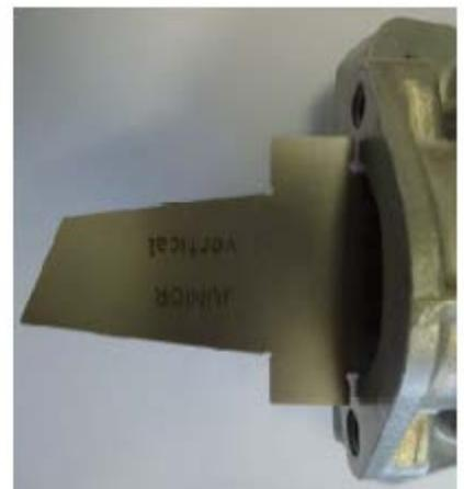
Die Lehre muss in der horizontalen sowie vertikalen Position so weit wie möglich in den Auslasskanal gedrückt werden. Die Lehre darf die Auslassfläche in keiner Richtung berühren.
