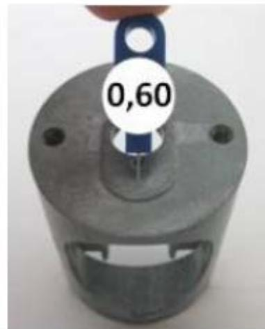
Vertikale Bohrung des Vergasereinsatzes
