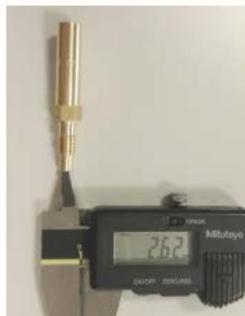
Durchmesser der oberen Bohrung 2,67 +/- 0,10mm
