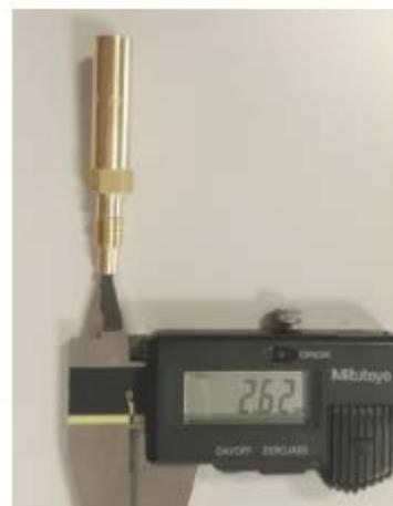
Durchmesser der oberen Bohrung 2,67 +/- 0,10mm
