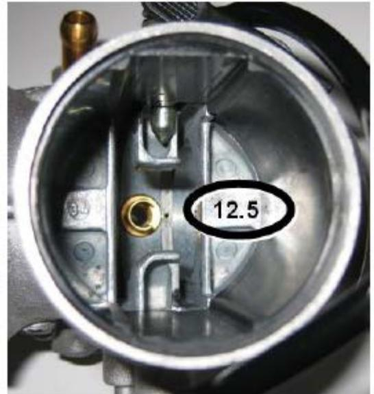
Bohrung des Vergasereinsatzes
