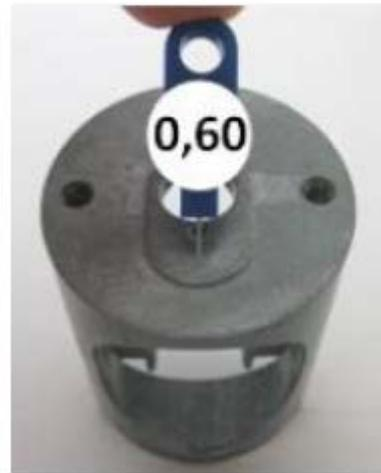
Vertikale Bohrung des Vergasereinsatzes
